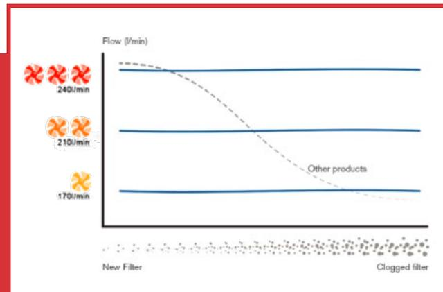
Dank eines eingebauten Sensors bleibt die eingestellte Luftmenge immer konstant.
