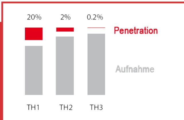
Mehr als 99,8% der Partikel werden herausgefiltert.
