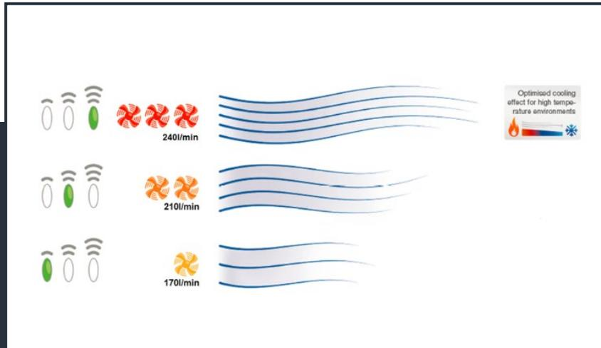
Einfache Wahl von drei unterschiedlichen Luftmengen von 170l/min bis 240l/min:
