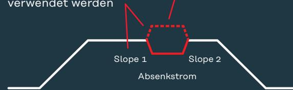
Der Absenkstrom wird nur beim WIG-4-Takt-Schweißen verwendet. Er ermöglicht es Ihnen, während des Schweißprozesses den Hauptstrom beliebig zu verringern oder zu erhöhen.
