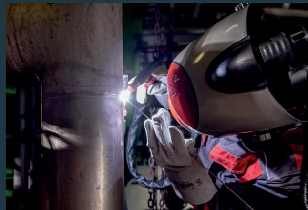
Alternativ kann 33 Minuten durchgehend WIG-geschweißt werden (bei 100 A)
