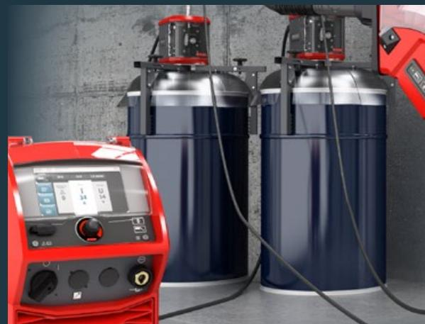
Automatisierter Wechsel zwischen zwei Drahtfässern
