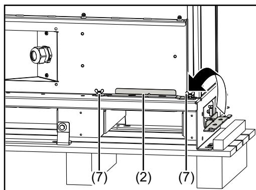
如果不需壁挂托架条 (2)，请将其存放在设备的背面，并使用蝶形螺母 (7) 进行固定。
