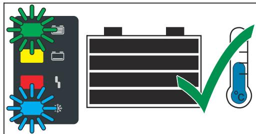
按照如下说明，为了获得最佳的蓄电池寿命，只有当蓝色“蓄电池冷却”指示灯和绿色指示灯同时点亮时，才能断开蓄电池与蓄电池充电器的连接。若同时使用了若干个蓄电池充电器，那么应首先断开已充满电时间最长（冷却最为充分）的蓄电池。
