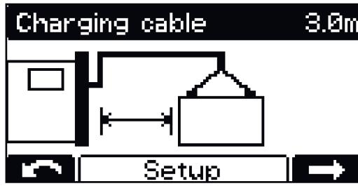
10 使用“上/下”按钮设置合适的充电电缆长度 (m / ft)。
