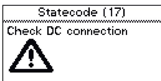
“直流连接”菜单包含直流连接检查设置。如果开启直流连接检查 (“ON”)，则会在充电过程中检查蓄电池充电器和蓄电池之间的连接。
