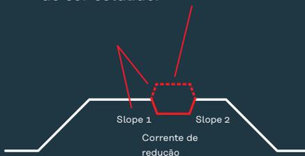
Dependendo da corrente de redução definida, pode ser utilizado um Up-Slope ou um Down-Slope.
