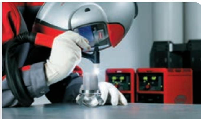
/ Soudage Microplasma manuel pour les épaisseurs à partir de 0,1 mm.
